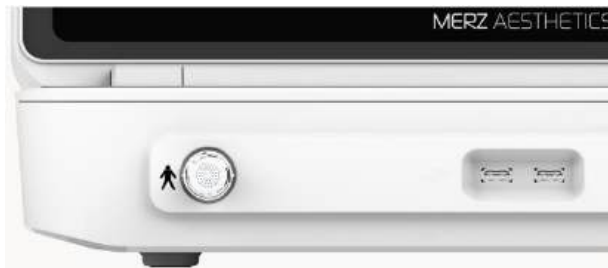
Figura 5.1: Receptáculo conector para pieza de mano
