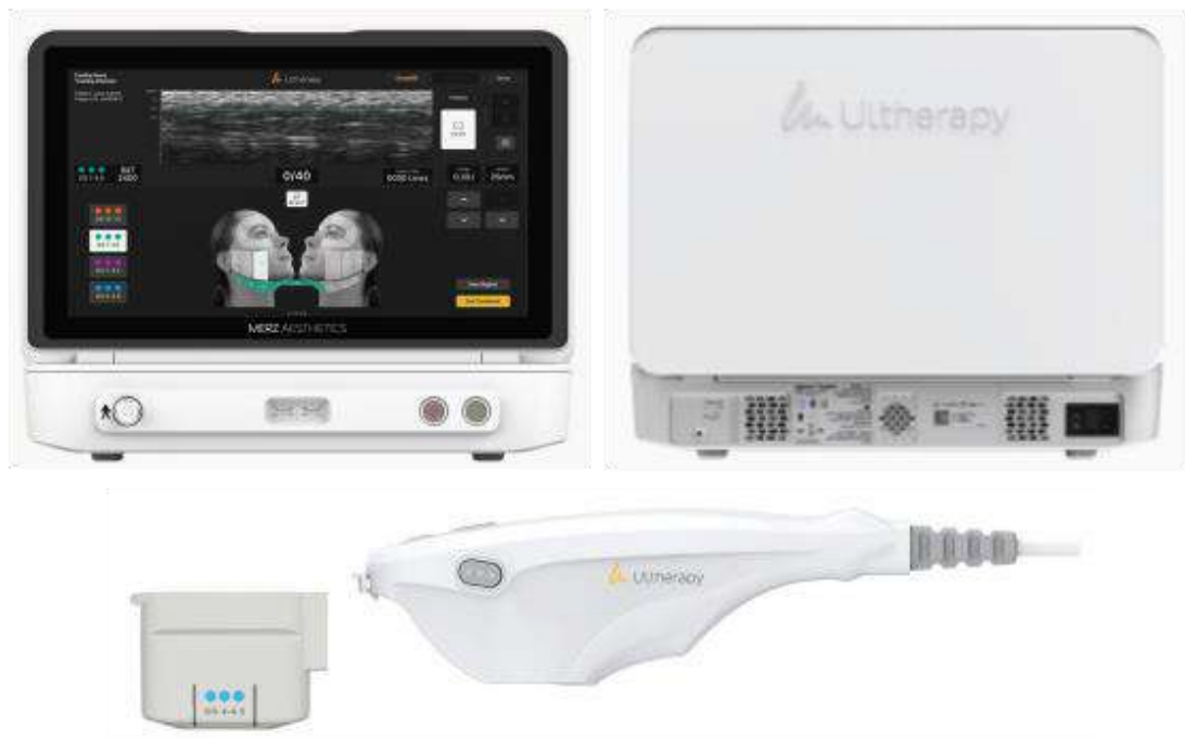
Figura 3.1: Principales componentes del Sistema Ulthera®: unidad de control (arriba), pieza de mano (abajo a la derecha) y transductor para adquisición de imágenes o aplicación de tratamiento (abajo a la izquierda) que se inserta en el receptáculo de la pieza de mano
